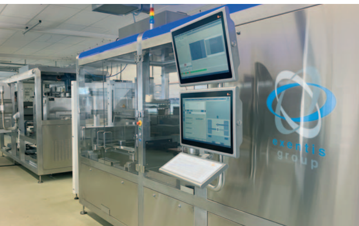
Exentis Pharma Produktionssysteme zur Herstellung innovativer Tabletten mit beliebig einstellbarem Wirkstoff-abgabeprofil im menschlichen Körper
