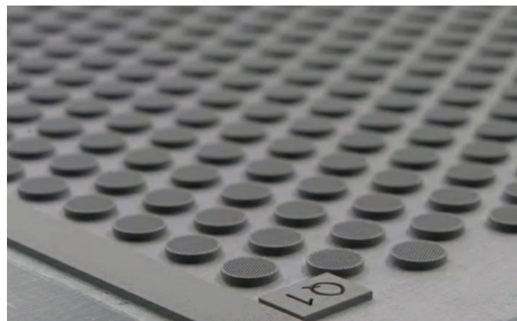
Fertigung von Mikro-Scheibenfiltern in Millionenstückzahl pro Jahr auf einem einzigen Exentis Produktionssystem
