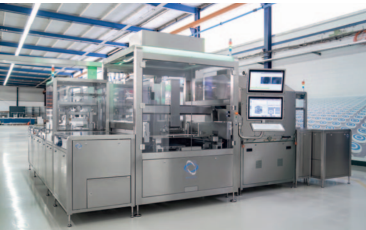
Exentis Pharma Produktionssystem zur Herstellung von Tabletten mit beliebig einstellbarem Wirkstoffabgabeprofil im menschlichen Körper
